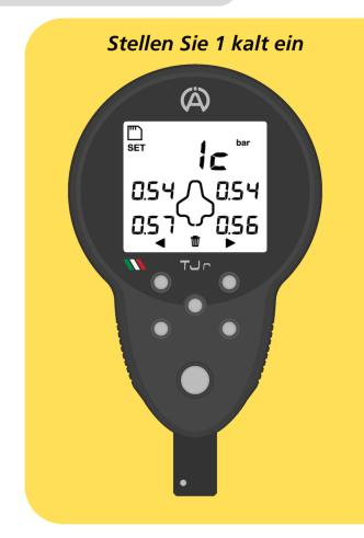
Um die Druckdifferenz des ausgewählten SET anzuzeigen, drücken Sie eine der beiden unteren Tasten, während der Kalt-SET oder Heiß-SET angezeigt wird
