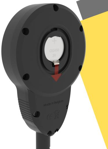
Legen Sie die neue Batterie mit dem positiven Ende nach oben ein und schieben Sie sie in den TJr, bis die Verriegelung einrastet
