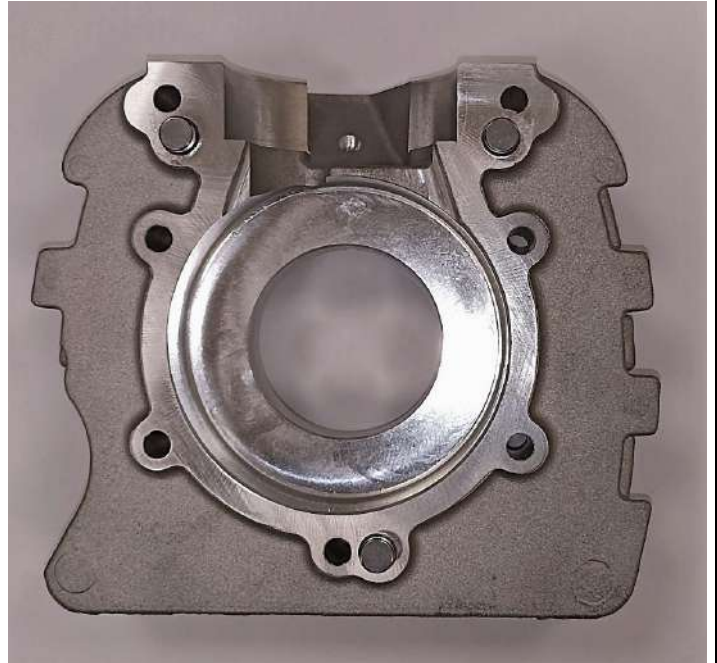
Photo de l'extérieur du carter gauche / Photo of the outside of the left crankcase
